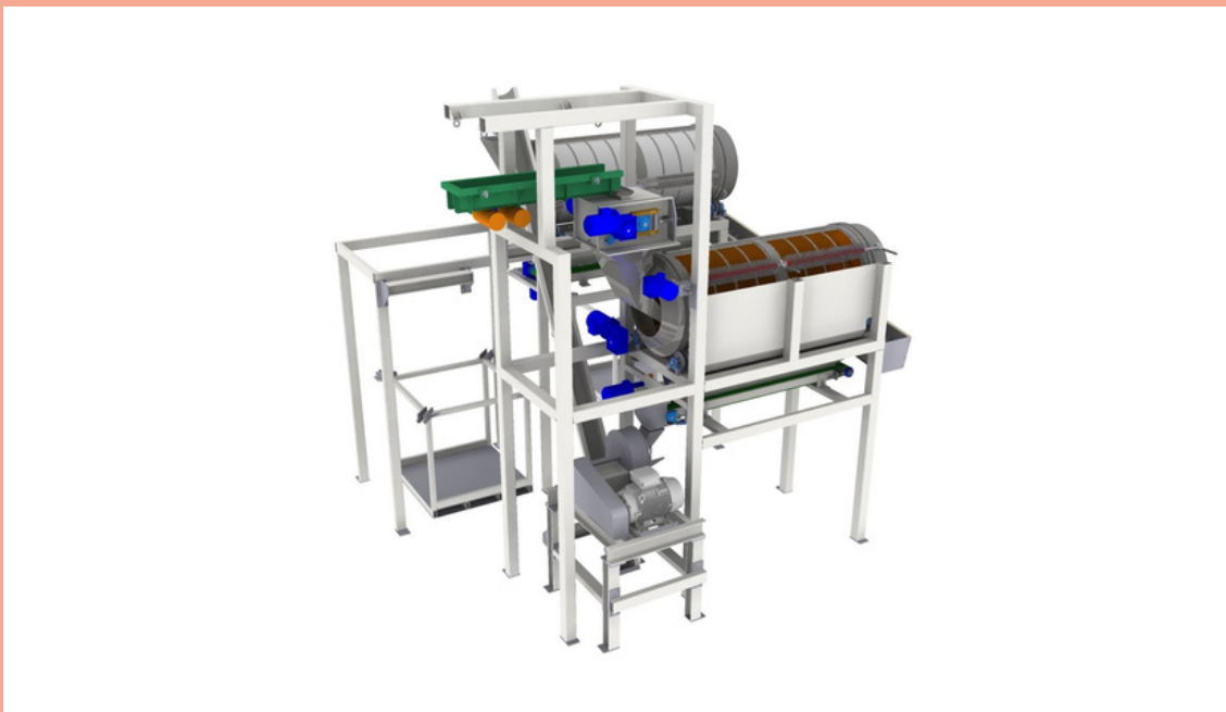
Diseño preliminar del prototipo para separar la membrana biológica de la cáscara de huevo (MAINCER, S.L.)
