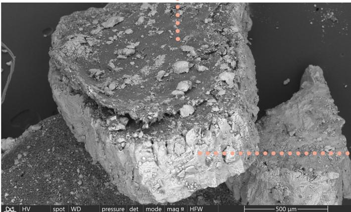
Partículas de cáscara con membrana previamente al proceso de separación
